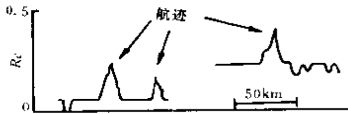
图 10.7 卫星辐射计通过海洋层云在可见光区的扫描图,表示船队通过时,使低层大气凝结核数量增加,引起云反射率的明显增强
